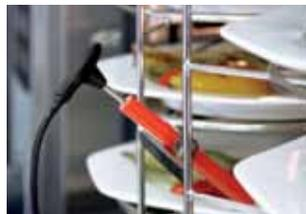
В режиме Finishing® «Банкет / тарелки» вставляйте термозонд в керамическую трубку на тележке-кассете для тарелок.
